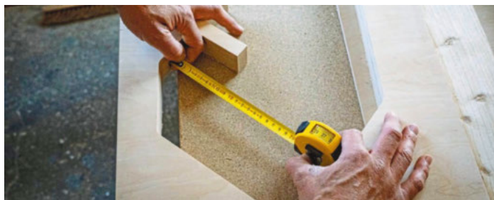
/ Das Taschenbandmaß BM 150 von Stabila verfügt über ein Sichtfenster, wodurch die Werte bei Innenmessungen schnell abgelesen werden können.
